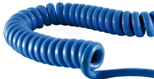
Les câbles spiralés PVC/PUR conviennent à des applications particulières dans les techniques de commande, de mesure et de régulation dans des installations à sécurité intrinsèque. Le câblage concentrique avec un blindage statique empêche les perturbations dans la zone de transmission. Le bandage en poly-voile garantit un blindage optimal à 100% aux basses et moyennes fréquences et filtre les perturbations électriques externes.
