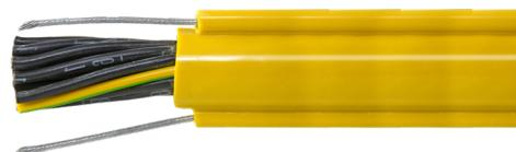
GIFAPLAST-2TY est un câble de commande avec deux câbles en acier encastrés latéralement dans la gaine extérieure. Le câble présente ainsi une résistance à la traction nettement plus élevée et est en grande partie exempt de torsions axiales. Les forces de traction générées sont absorbées par deux câbles en acier sans torsion, reliés à la gaine extérieure parallèlement à l'axe. Gifaplast-2TY possède une gaine extérieure robuste, résistante au froid et aux intempéries.
