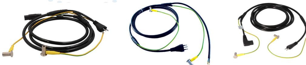
Le GIFAS-Câble pour appareils d'hôpitaux a été spécialement développé pour les hôpitaux de soins aigus avec salles d'opération et unités de soins intensifs. Il relie les appareils électriques à la source de tension et compense en même temps le potentiel avec le fil de terre. Grâce au toron concentrique, le câble PUR reste extrêmement flexible.
